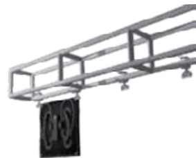
Шаг 2: Присоедините панели экрана к соединительным блокам для подвеса
